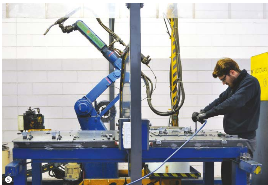
Figura 5: Una fase di produzione con robot di saldatura.
