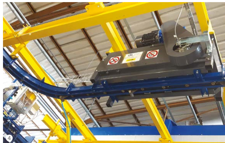
Figura 4: Dettaglio del gruppo traino e lubrificatore su un convogliatore CM.
